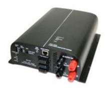
Les chargeurs SBC permettent la recharge de tous les types de batteries. Ils sont entièrement automatiques et peuvent être branchés en permanence. Ils sont équipés en facade de voyants de contrôles pour visualiser l'avancée de la charge et de sélecteurs pour une utilisation en mode alimentation ou encore sélectionner le type de batterie à recharger.
